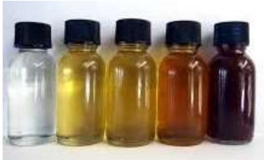
*Ilustración 1 Variación de color de aceite dieléctrico sin importar su contenido de PCB*
