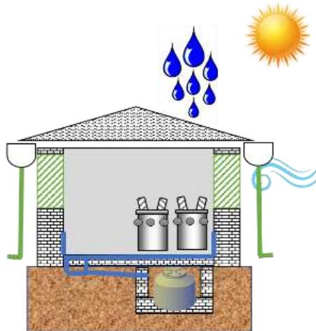
Ilustración 15 Vista esquemática de bodega de almacenaje para equipos contaminados con PCB
