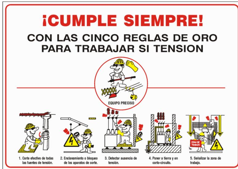
Ilustración 1 Reglas de oro para trabajar con equipos eléctricos<sup>1</sup>
