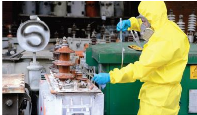
Ilustración 23 Toma de muestra en equipo desechado
