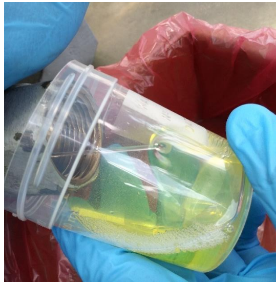
Ilustración 21 Aceite proyectado a alta velocidad siendo captado por el vaso de toma de muestras.
