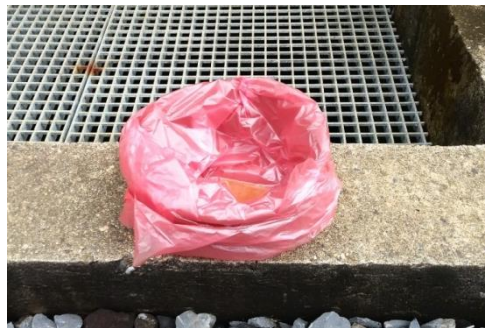
Ilustración 8 Vista de bolsa y palangana con recubrimiento siendo usadas en una operación de toma de muestras
