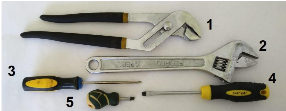
Ilustración 18 (1) Llave stillson, (2) Llave francesa, (3) desarmador de castigadera en cruz (Phillips), (4) desarmador de castigadera plana, (5) desarmador de castigadera plana corto
