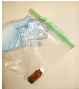
Ilustración 15 Bolsa con cierre hermético con muestra en su interior
