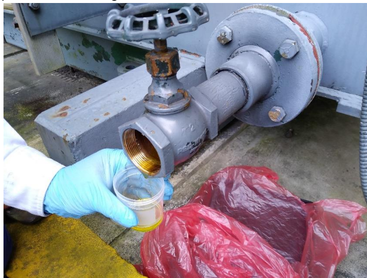
Ilustración 22 Muestreo de PCB en equipo con válvula con tapón de rosca
