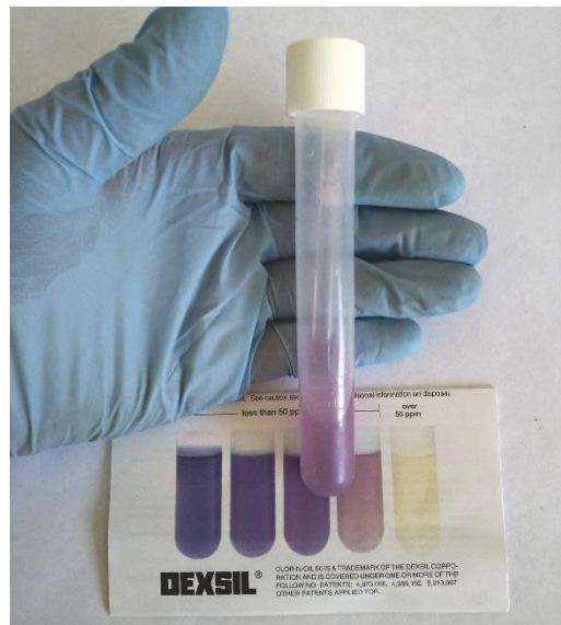
Ilustración 3 Resultado negativo de análisis colorimétrico con kit Clor-N-Oil.
