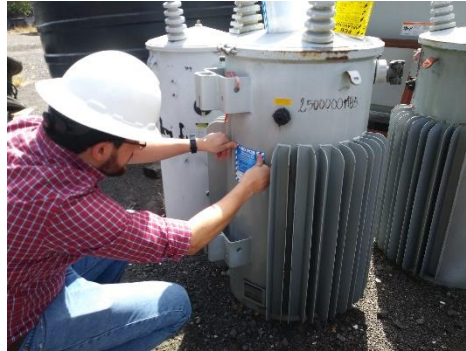
Ilustración 8 Etiquetado de equipos según resultados del análisis de PCB.
