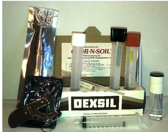
Ilustración 2 Kit Clor- N -Soil
