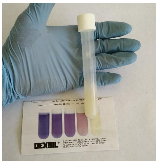
Ilustración 4 Resultado positivo de análisis colorimétrico con kit Clor-N-Oil.
