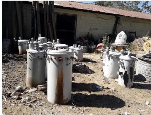
Ilustración 15 Vista de un equipo con derrame de aceite que falló por desbalance de carga
