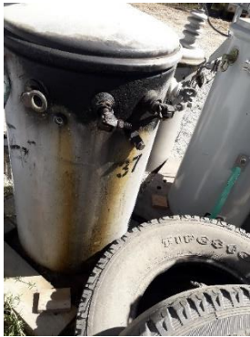
Ilustración 15 Vista de un equipo con derrame de aceite que falló por desbalance de carga
