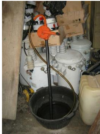
Ilustración 18 Evidencia de reúso de aceites con alta probabilidad de contaminación con PCB
