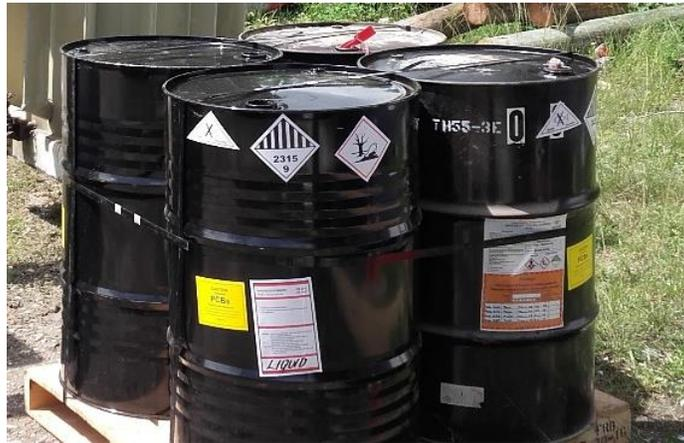
*Ilustración 3 Residuos sólidos contaminados con PCB envasados y embalados*
