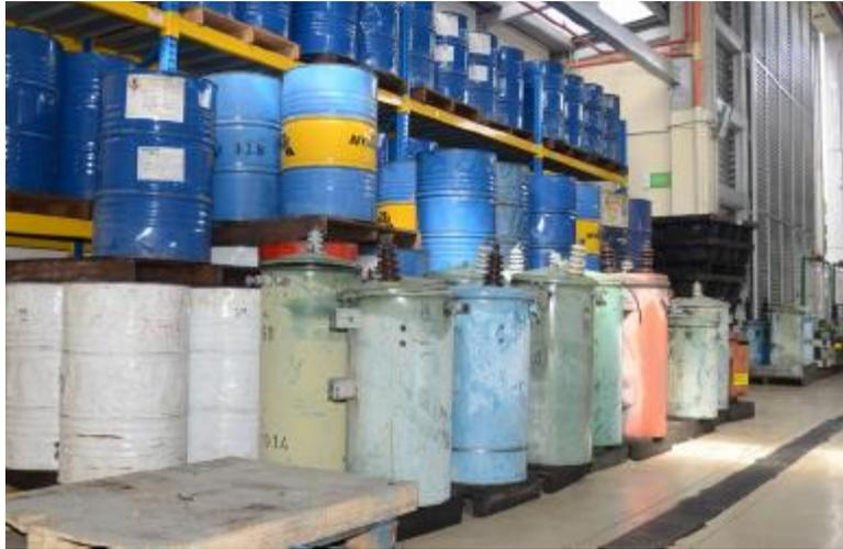
*Ilustración 11 Residuos peligrosos generados en actividades de mantenimiento de equipos con aceites dieléctricos*
