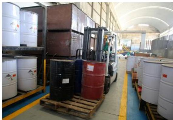
*Ilustración 10 Actividades de almacenamiento y movilización interna de residuos contaminados con PCB*
