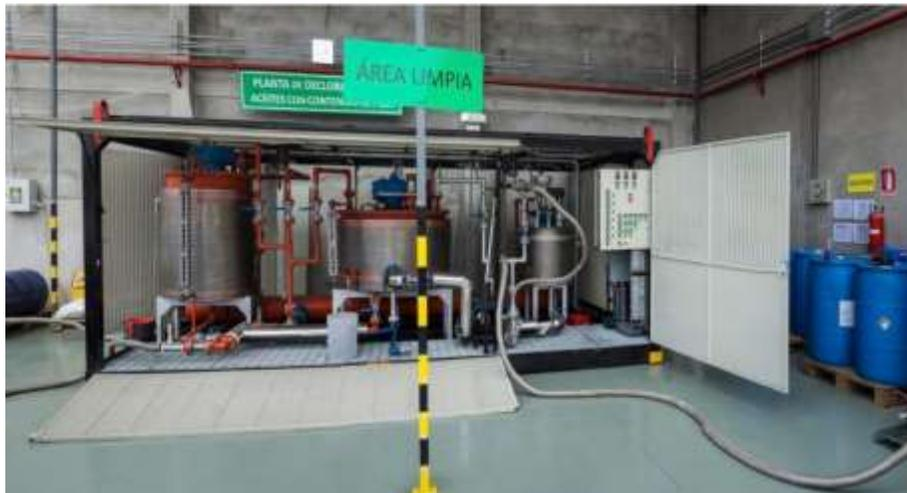
*Ilustración 5. Vista de una planta de dechlorinación*
